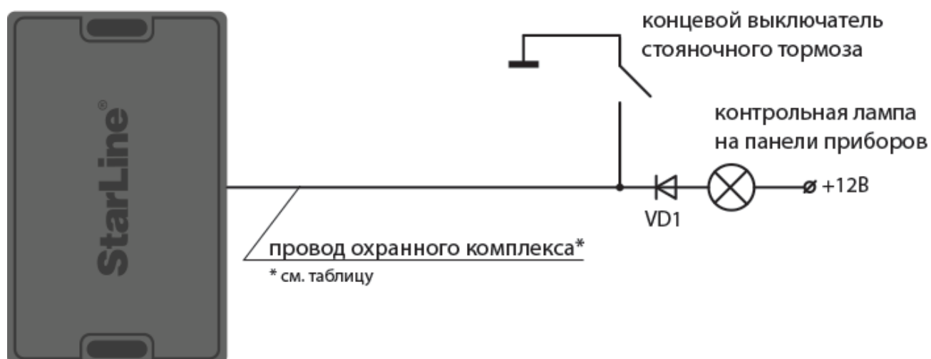
Схема подключения стояночного тормоза
