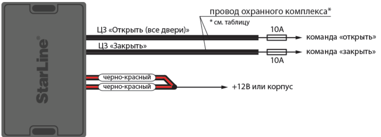
Схема аналогового подключения центрального замка с положительным или отрицательным силовым управлением для охранных комплексов StarLine A96/A66, B96/B66, D96/D66, AS96 (v2)
